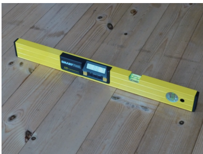
水平器による床の傾きの計測
