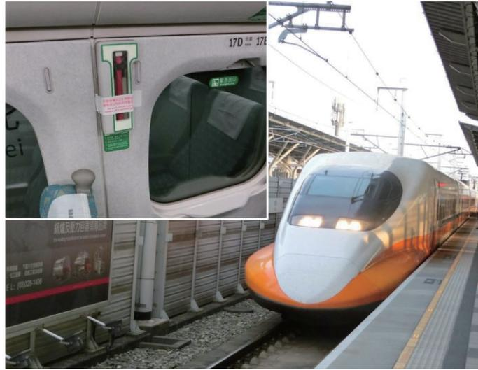
写真1 台湾の新幹線と各車中と各扉に設置してあるハンマー
