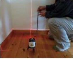
「床の傾きを計測する」調査機器
