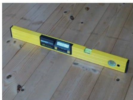
水平器による床の傾きの計測
