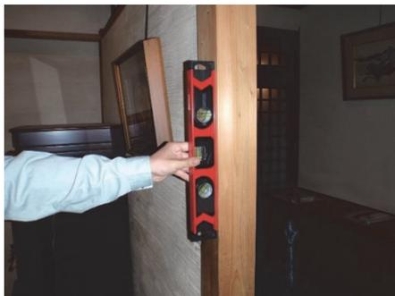
水平器による柱の傾きの計測
